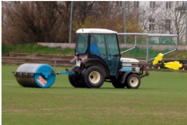
Walzen verdichtet den Boden.
