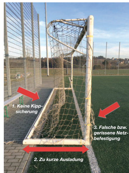
Unzulässiges Fußballtor, Bildunterschrift: Diese Tor entspricht nicht der aktuellen DIN Norm.
