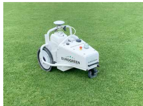
Der GPS-gesteuerte LinoStar. Einfacher geht Markieren nicht
